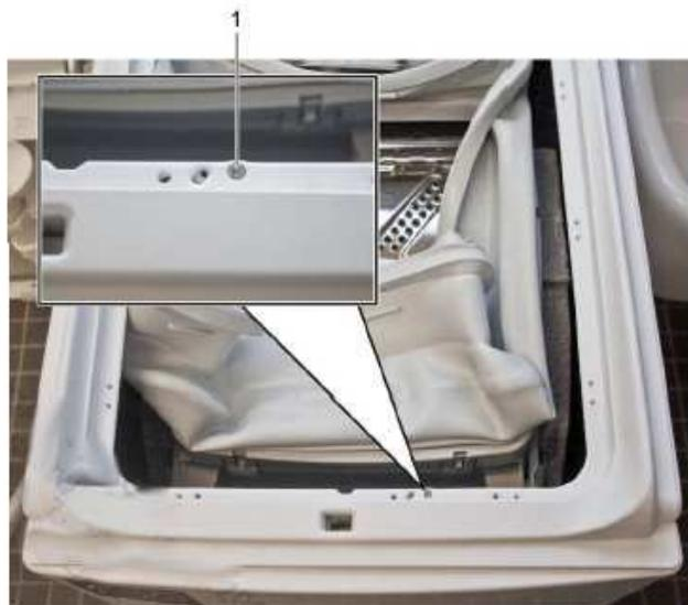
2. Pousser le verrouillage couvercle dans le support jusqu'à ce que le crochet se clipse.
