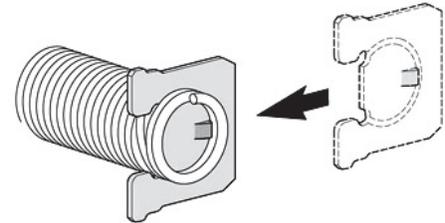
Insérer la plaque support métallique (3) sur le socle à l'aide d'un marteau.
