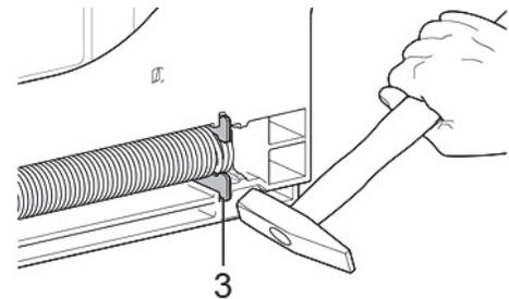
Positionner correctement le support plastique dans le socle.
