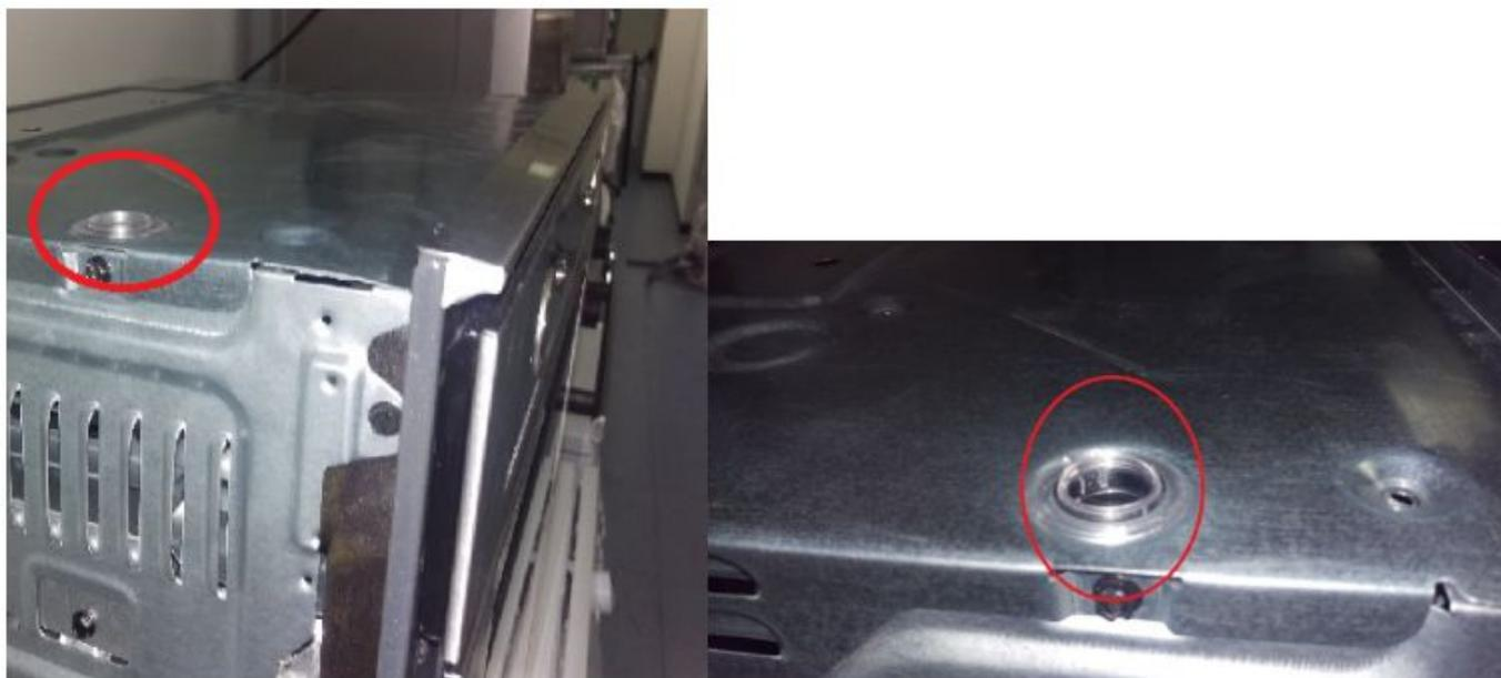
Dans le cas où la tôle supérieure serait démontée, il sera alors nécessaire d'occulter les photorécepteurs.
