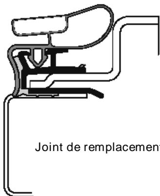
Joint de remplacement installé
