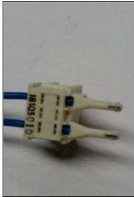
Insérer les 2 fils dans les trous prévus à cet effet jusqu'en butée
