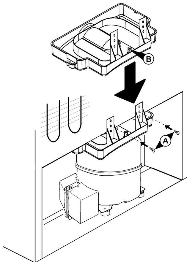
Pour des raisons de standardisation des composants et pour faciliter le remplacement de l'article en objet, nous avons réalisé un nouveau BAC D'EVAPORATION POUR COMPRESSEUR, qui peut-être utilisé en remplacement de la plupart des bacs d'évaporation montés à l'origine en production, sur les réfrigérateurs et congélateurs produits par notre Groupe.
